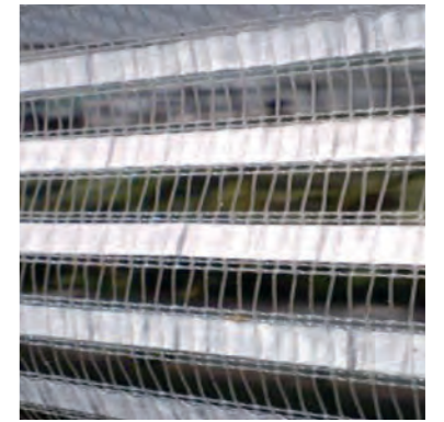
図14 光反射資材織り込みネット光反射資材がスリット状に交織されている
