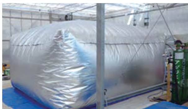
図19 すくすくバッグシステム（日本液炭（株）製）装置外観と内部の状況
