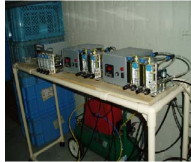
写真4：エチレンと空気の流量計
