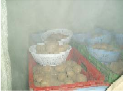
写真 4. 実験庫内部、加湿噴霧の状態
